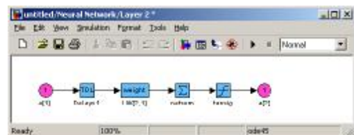
Рис. 7. Структурна схема другого шару ШНМ
