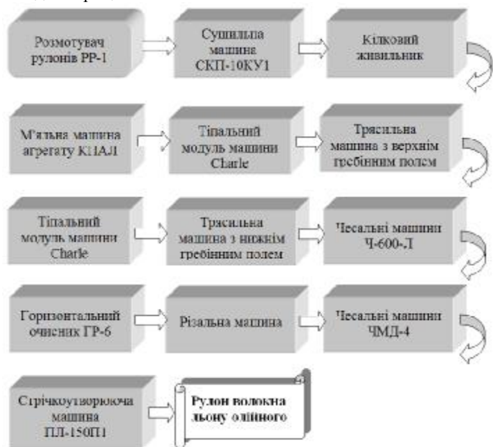
Рис. 5. Технологічна лінія для отримання очищеного волокна із трести льону олійного
