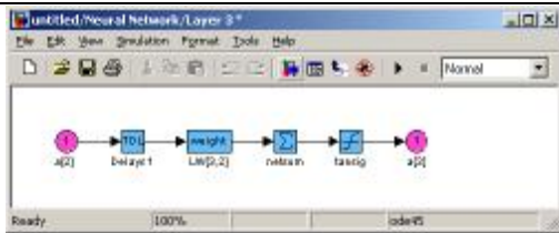
Рис. 8. Структурна схема третього шару ШНМ
