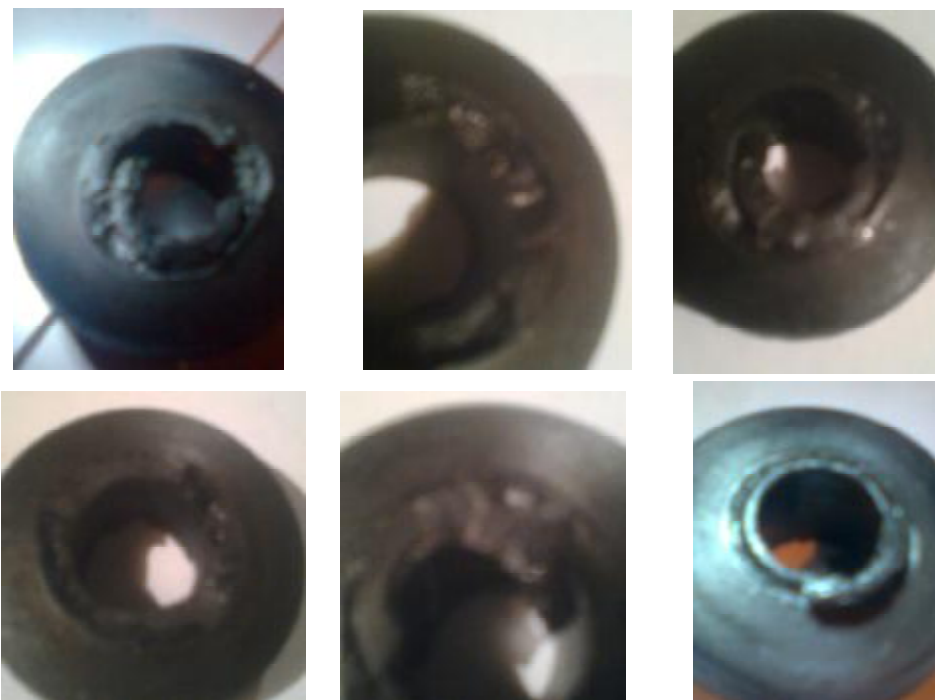
Рис. 2. Виды разрушений краев внутреннего отверстия резиновых элементов
