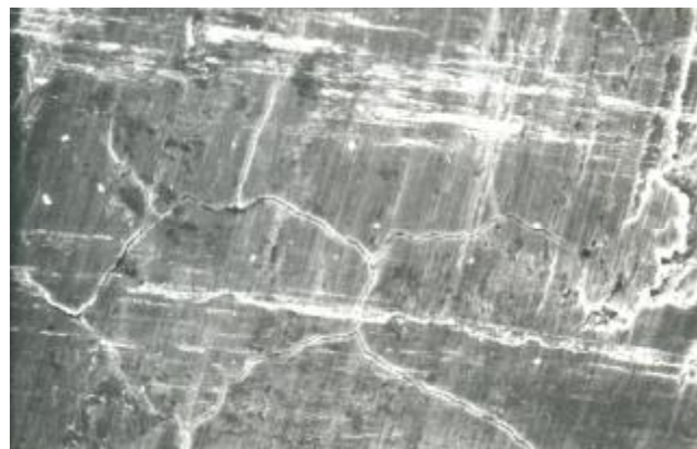
Рис. 7. Микроструктура поверхностей трения покрытий
