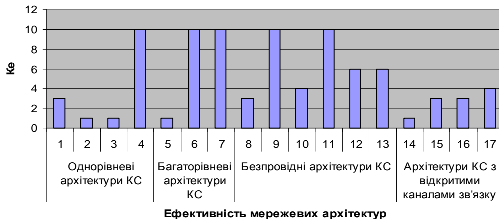
Рис. 1. Ефективність мережних архітектур за параметром емерджентності. Однорівневі: 1 – зіркова; 2 – моноканал; 3 – кільцева; 4 – систолічна. Багаторівневі: 5 – ієрархічна; 6 – зірково-магістральна; 7 – мереживо-ієрархічна; безпровідні: 8 – з пасивним ретранслятором; 9 – безретрансляційні; 10 – з активним ретранслятором; 11 – зірково-магістральна; 12 – з активним ретранслятором та кільцевою структурою; 13 – сотова. З відкритими оптичними каналами зв'язку: 14 – високошвидкісна дуплексна; 15 – середньошвидкісна кільцева; 16 – низькошвидкісна кільцева; 17 – розгалужена
