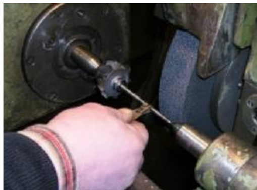
Рис. 8. Операція полірування вала ротора
