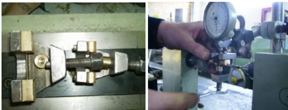
Рис. 6. Процес правлення вала ротора ручним пресом
