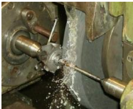
Рис. 7. Операція шліфування ротора турбокомпресора ТКР-7 Н1
