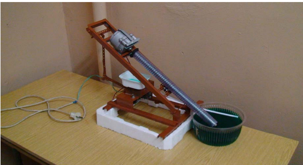
Рис. 4. Діюча модель шнекового насоса нової конструкції
