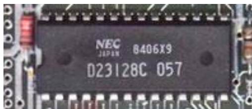
Рис. 3. PROM D23128 на платі ПК "ZX Spectrum", фрагмент [4]
