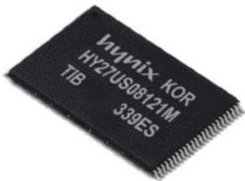
Рис. 5. Мікросхема флеш-пам'яті фірми "Hynix" 512Mbit у корпусі TSOP
