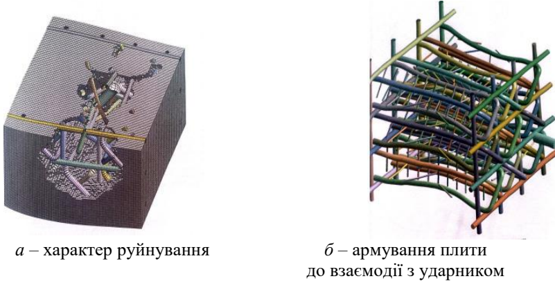
Рис. 1. Особливості проникнення ударника в плиту з комбінованим армуванням
