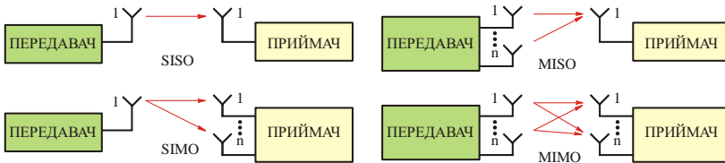
Рис. 2. Представлення каналів зв'язку: SISO, SIMO, MISO, MIMO
