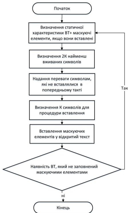
Рисунок 1 - Загальна схема алгоритму вставлення маскуючих елементів
