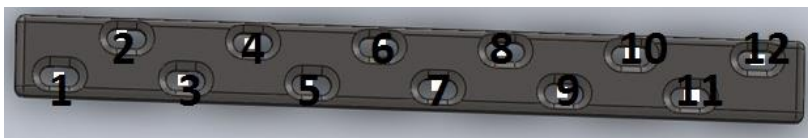
Рис. 1. Общий вид наkostной пластины с номерами отверстий для фиксирующих и блокирующих винтов
