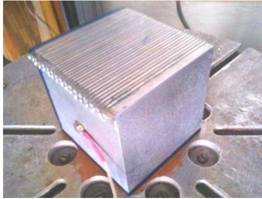
Рис. 1. Модель електростатичного кріпильного пристрою у формі куба
